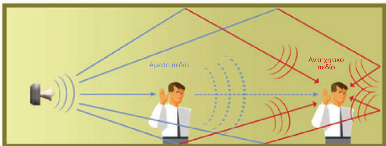
Σχήμα 3.3 Κοντά στην ηχητική πηγή, ο περισσότερος θόρυβος προέρχεται απευθείας από την ίδια την πηγή: η περιοχή αυτή ονομάζεται «άμεσο πεδίο». Μακρύτερα από την ηχητική πηγή, κυριαρχεί ο ανακλώμενος ήχος: η περιοχή αυτή ονομάζεται «πεδίο αντήχησης».
