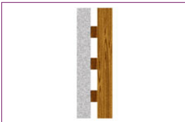
Σχήμα 3.7 Τα «διαφράγματα» είναι ξύλινα πάνελ που στερεώνονται στους τοίχους με τη βοήθεια τάκων. Μετριάζουν ήχους σε χαμηλές συχνότητες.
