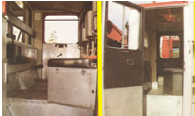
Σχήμα 4.16 Μεταφορές – Η μείωση του θορύβου στην καμπίνα του εικονιζόμενου οχήματος μεταφοράς προσωπικού επιτυγχάνεται μέσω της επένδυσης του δαπέδου και των πλευρικών τοιχωμάτων με υαλόνημα (fibreglass) που φέρει επιστρώση από φύλλο χάλυβα, ενώ οι υπόλοιπες επιφάνειες καλύπτονται με ηχοαπορροφητικό υλικό © Χορηγία του Health & Safety Executive, Ηνωμένο Βασίλειο
