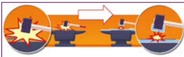
Σχήμα 4.8 Πηγές στερεόφερτου ήχου: επιδράστε στις δυνάμεις ή στη δομή του εξοπλισμού.
