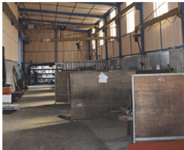
Σχήμα 4.18 Κατεργασία μεταλλικών μερών – Προπετάσματα © Yves Cousson – Χορηγία του INRS – Γαλλία
