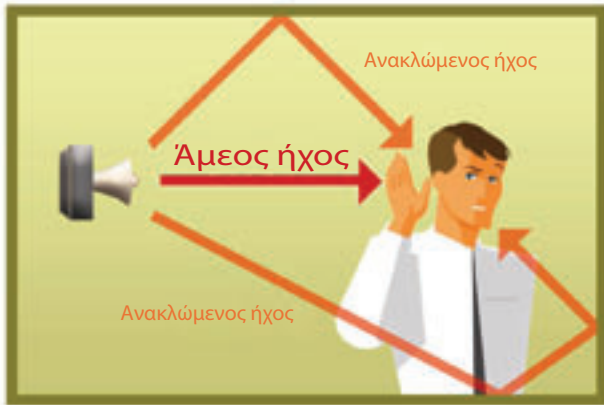
Σχήμα 3.1: Ο ήχος που εκπέμπεται από ακουστική πηγή ανακλάται στους τοίχους του χώρου εργασίας. Η έκθεση του εργαζόμενου συνδυάζει τους άμεσους με τους ανακλώμενους ήχους.
