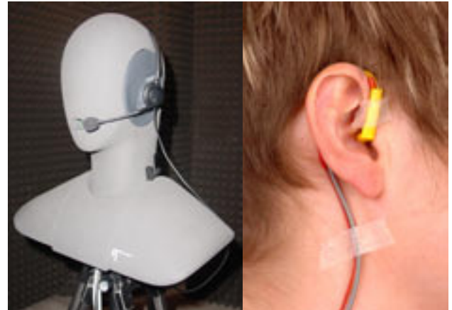
Σχήμα 2.13 Μετρήσεις θορύβου στο αυτί με τις μεθόδους HATS και MIRE © και χορηγία του Health and Safety Executive – Μεγάλη Βρετανία Προσομοιωτής κεφαλής και κορμού (πηγή: HEAD Acoustics GmbH, Γερμανία) MIRE
