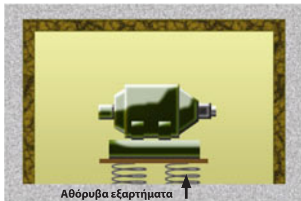
Σχήμα 4.14 Περίβλημα θορυβώδους εξοπλισμού.
